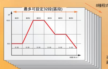
亦適用於複雜的溫度控制，每個程式可設定32段，總共能設定256段。
