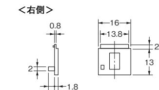
\*形A7MDは、ねじ締めパネル取りつけ、ワンタッチパネル取りつけができません。プリント基板装着後、プリント基板をパネルに固定して取りつけてください。
